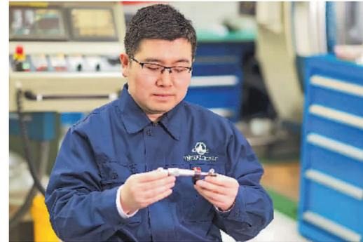
度极大，许多师傅都因超差而加工失败。他主动请缨，从分析超差产生的原因、材料的特点等方面入手，用数控机床精雕细琢，最终加工出来的舵面对称度达到0.02毫米的超高精度。
