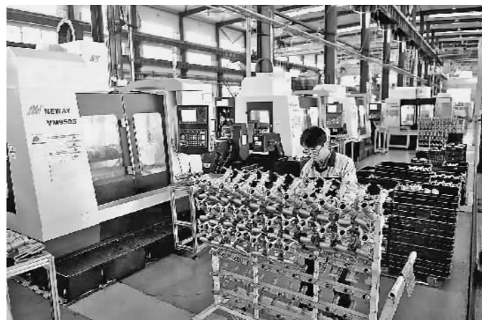
在北方重工汽车转向系统分厂的加工车间,工人在使用数控加工中心加工铝合金柱管零件。
